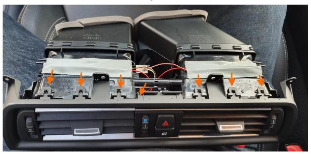
An der Blende ist ein Bügel "verschweißt" der verhindert das die Lamellen herausfallen. Den Bügel mit einem Flachschraubendreher heraus hebeln und die Lamellen entfernen:
