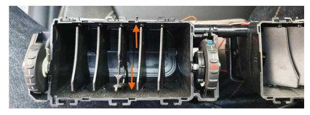
An geeigneter Stelle mit dem Stufenbohrer ein Loch bohren. Es sollte mindestens so groß sein (14mm) dass das Displaykabel durch passt. Die Bohrung etwas entgraten damit keine scharfen Kanten das Kabel beschädigen.
