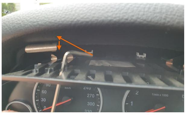
Am Kombiinstrument den Stecker lösen. Dabei die Nase am Stecker drücken:
