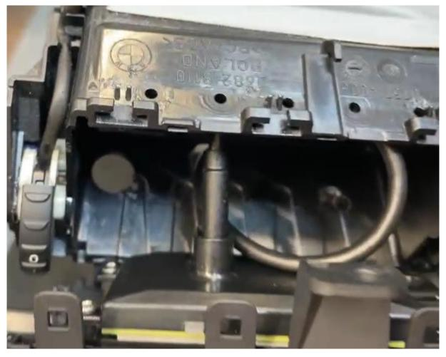
Das Display mit der Blende vorsichtig wieder auf das Gehäuse des Frischluftgrills setzten. Den Frischluftgrill wieder an die Zierleiste anbringen.
