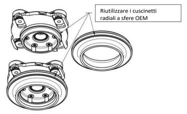
7. Tutti i componenti del puntone della sospensione (ammortizzatore, molla, parapolvere, paracolpi, cuscinetto della molla, cuscinetto del puntone regolabile con cuscinetto a sfera scanalato, adattatore della molla e dado di bloccaggio possono essere rimontati. La coppia di serraggio del controdado originale è riportata nelle specifiche del costruttore del veicolo.
