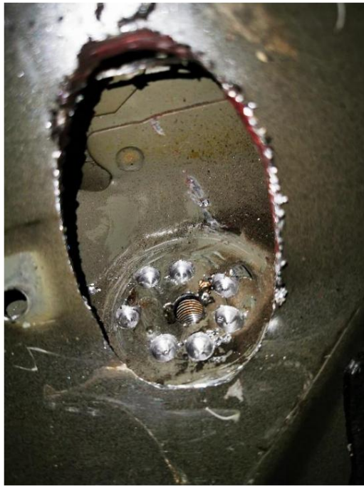
Image en haut à gauche : Perçage du cercle de trous à travers la plaque de longeron sur le manchon
