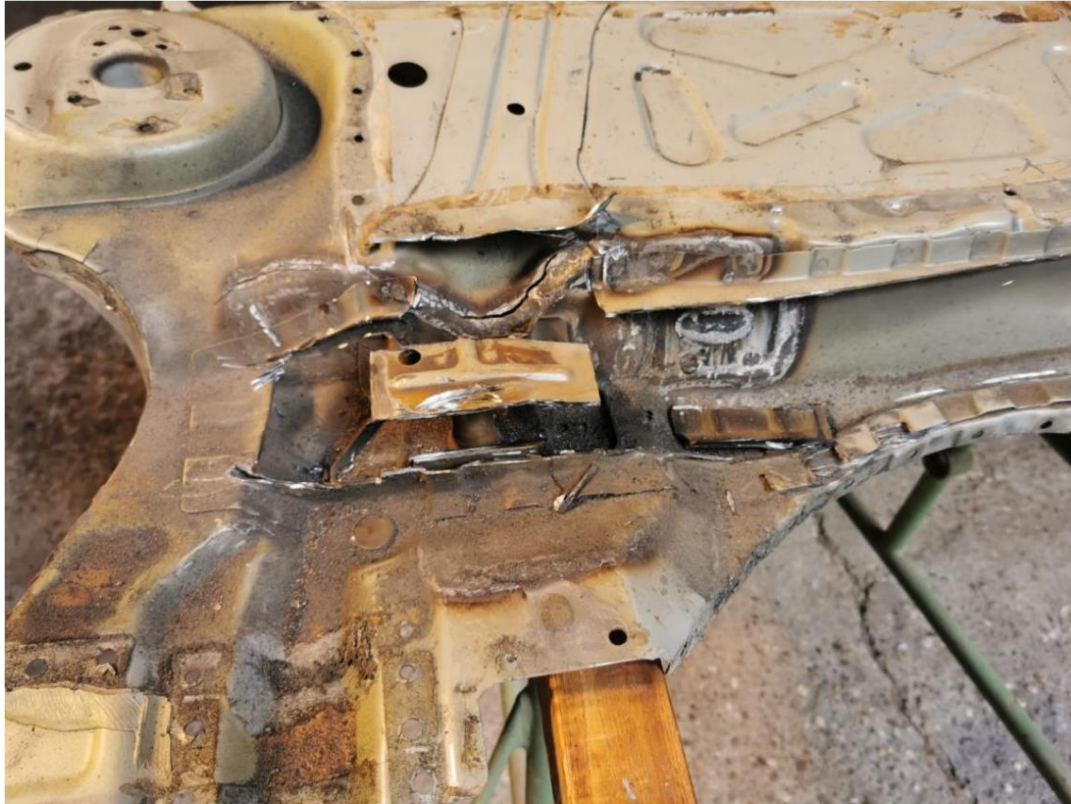
Photo ci-dessus : Montant intérieur divisé (montant arrière, devant le logement de la roue de secours) et haut de la manchon fileté
