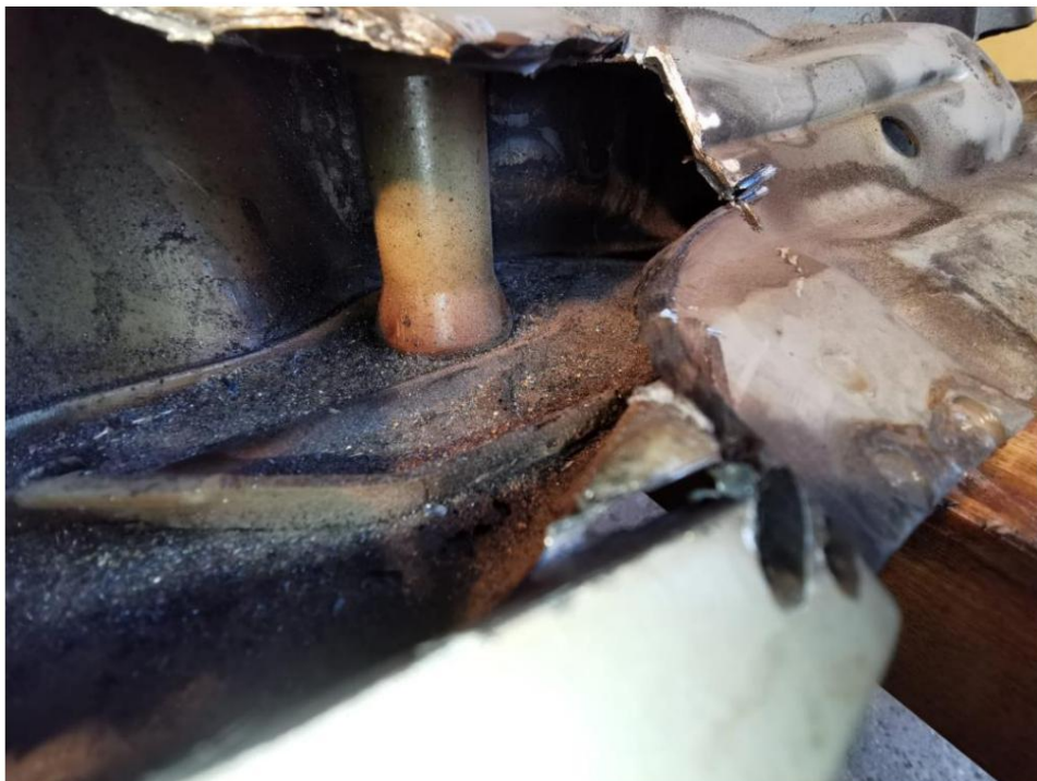
Photo ci-dessous : longeron intérieur, raccordement du manchon fileté (point de vissage de l'essieu arrière)
