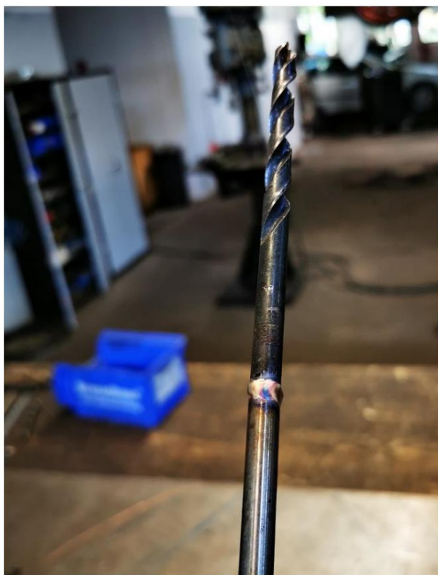
Image ci-dessus : Foret allongé avec un long tranchant latéral. Il doit être raccourci pour éviter que les tranchants latéraux n'endommagent le manchon fileté/filetage du mandrin. Vous pouvez également utiliser un foret de diamètre inférieur.
