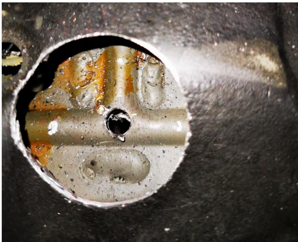
Image ci-dessus : Supports arrière après perçage avec le gaufrage visible
