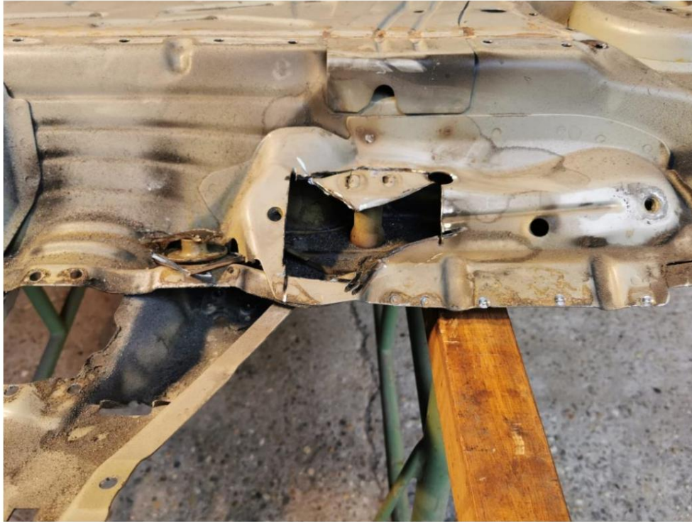
Photo ci-dessus : Montant extérieur divisé (montant avant, sous la banquette arrière) et haut de la manchon fileté
