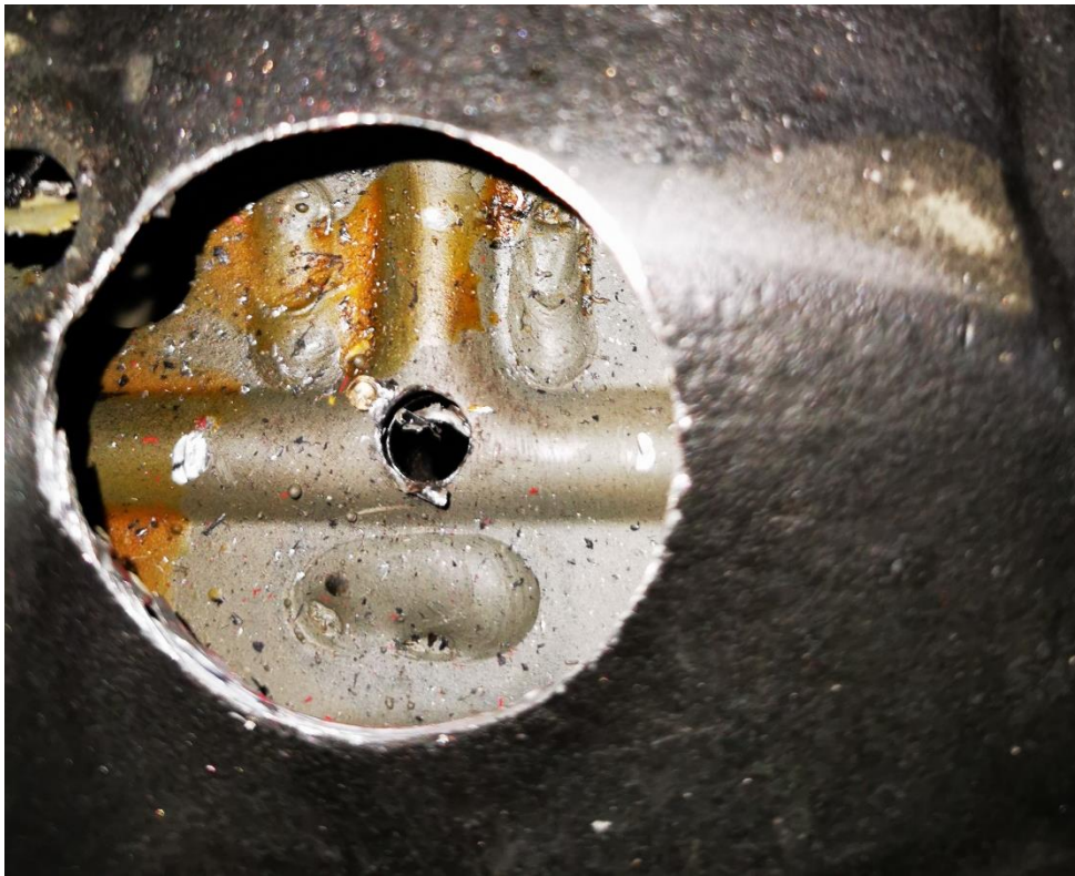
Bild Oben: Hintere Aufnahmen nach dem Aufbohren mit der sichtbaren Prägung
