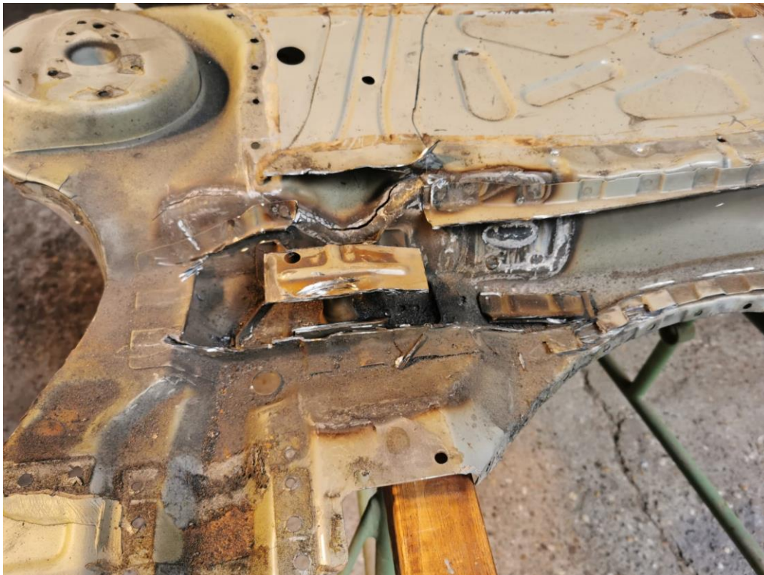
Bild Oben: Aufgetrennter Innenholm (hinterer Holm, vor Reserveradwanne) und Oberseite der Gewindehülse
