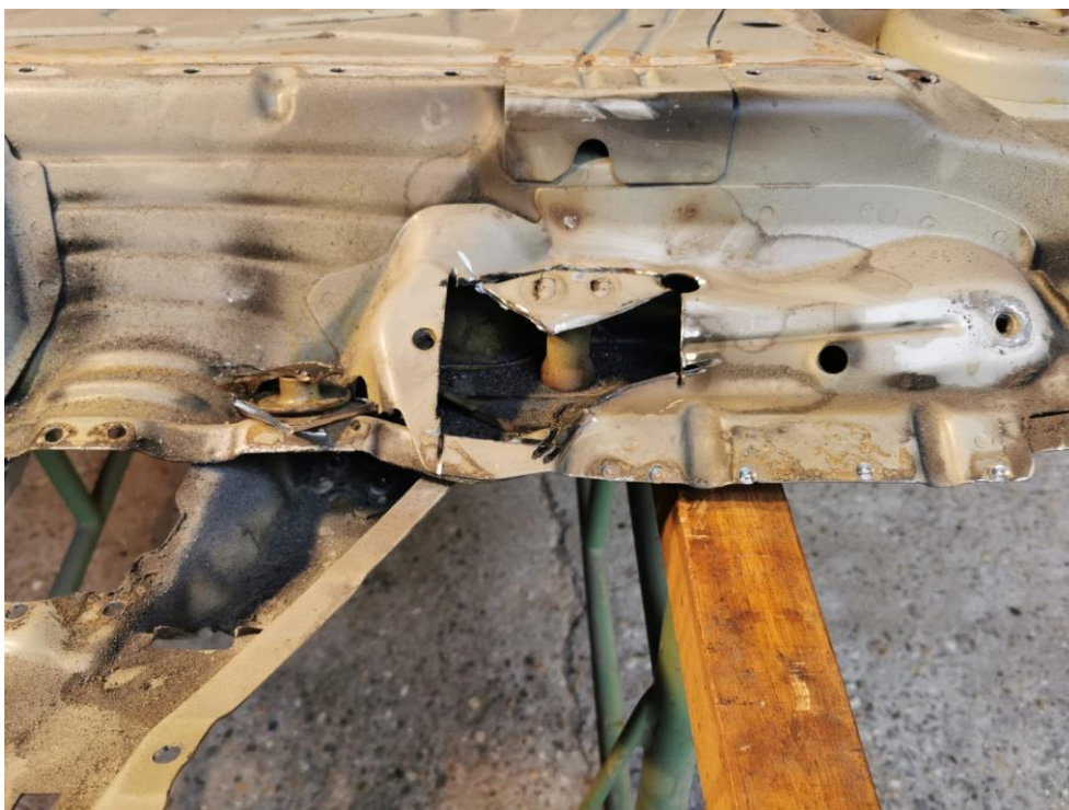
Bild Oben: Aufgetrennter Außenholm (Vorderer Holm, unter Rücksitzbank) und Oberseite der Gewindehülse
