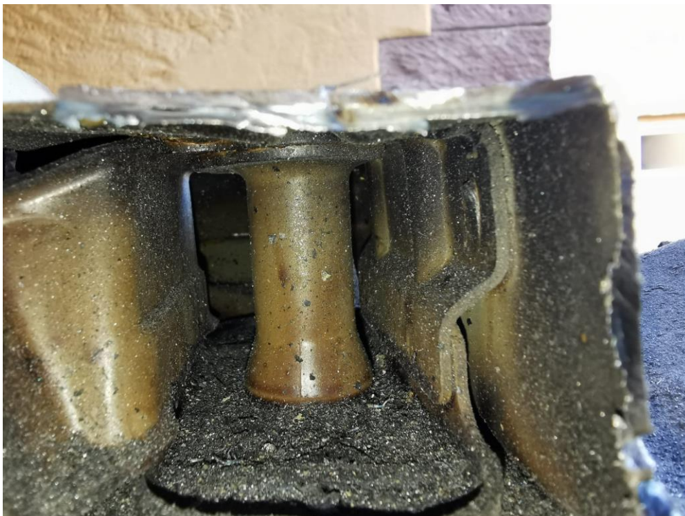
Bild Unten: Innenholm, Anbindung der Gewindehülse (Anschaubpunkt der Hinterachse)
