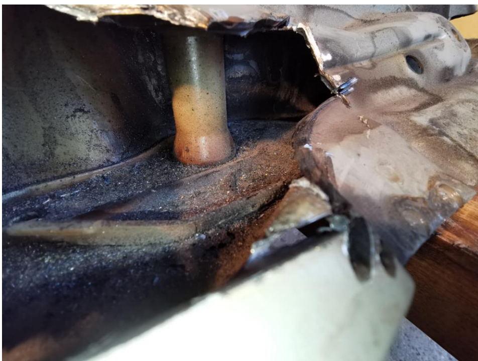
Bild Unten: Innenholm, Anbindung der Gewindehülse (Anschraubpunkt der Hinterachse)
