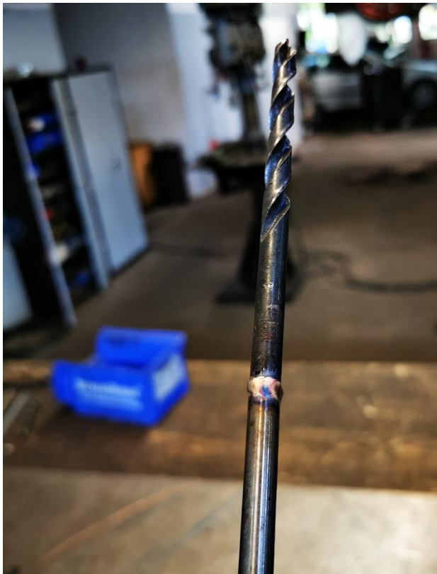
Bild Oben: Verlängerter Bohrer mit langer Seitenschneide. Sollte gekürzt werden, damit die Seitenschneiden nicht die Gewindehülse / das Gewinde der Aufnahme verletzen können. Alternativ: Bohrer mit kleinem Durchmesser nehmen.
