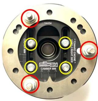
Las tuercas marcadas en rojo se utilizan para atornillar el rodamiento a la cúpula del vehículo (par de apriete: 25 Nm) y deben aflojarse para ajustar la inclinación y poder mover el rodamiento transversalmente.
